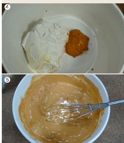
Préparation d'un badigeon avec une chaux en pâte
