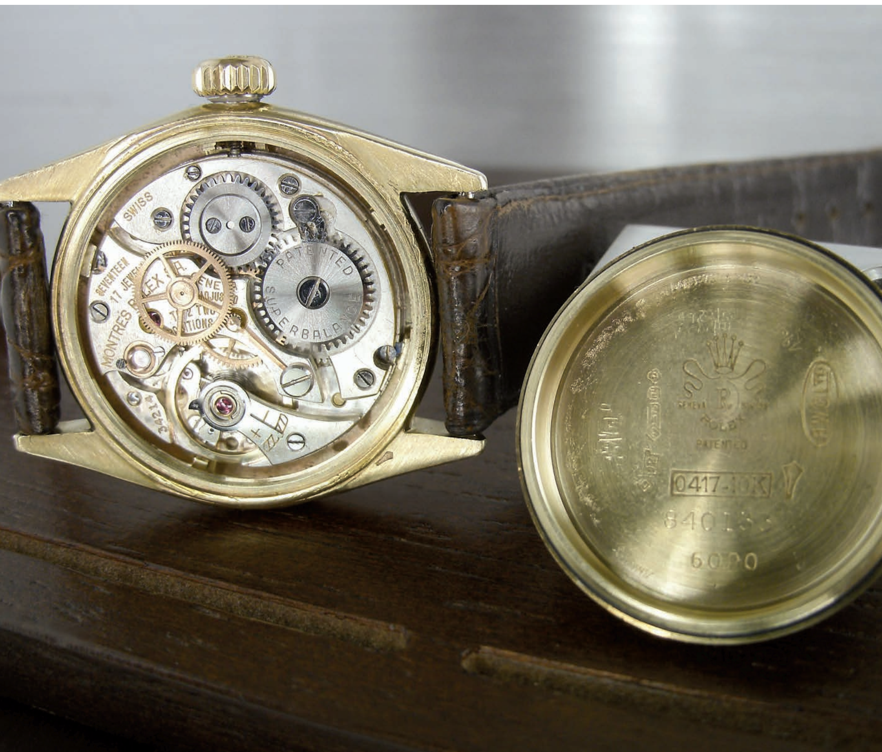
Mouvement Rolex Speed King manuel à seconde centrale.
