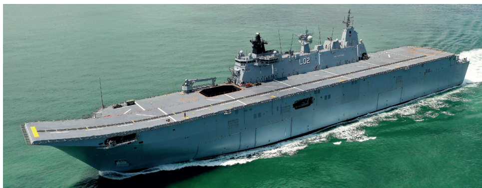
Les deux JUAN CARLOS I australiens, Canberra et Adelaide , disposent d'un tremplin mais pas du pont d'envol renforcé pour recevoir des F-35B. Ils peuvent lancer des drones. (P. Sinke)
