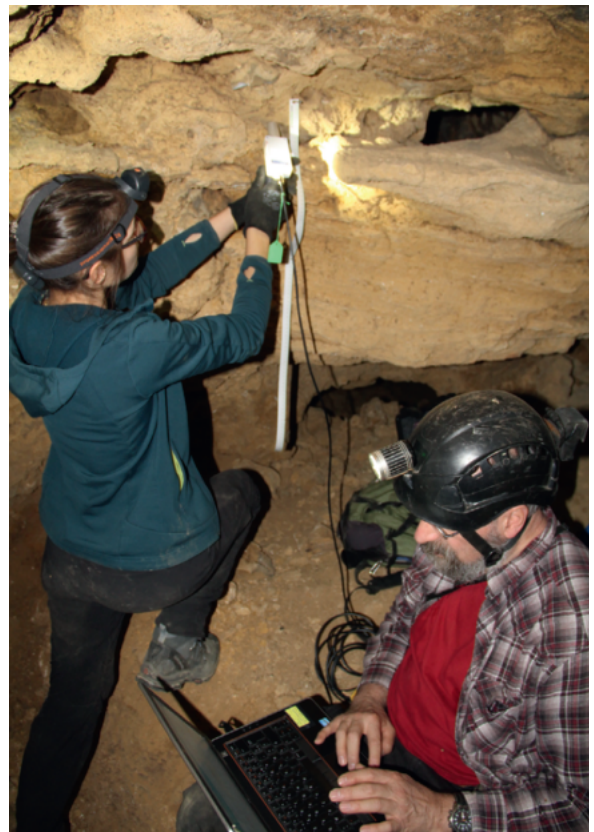
Figure 1.7. Analyse de la susceptibilité magnétique d'un remplissage de grotte.
