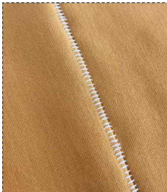
Le point flatlock, sur l'envers du tissu.
