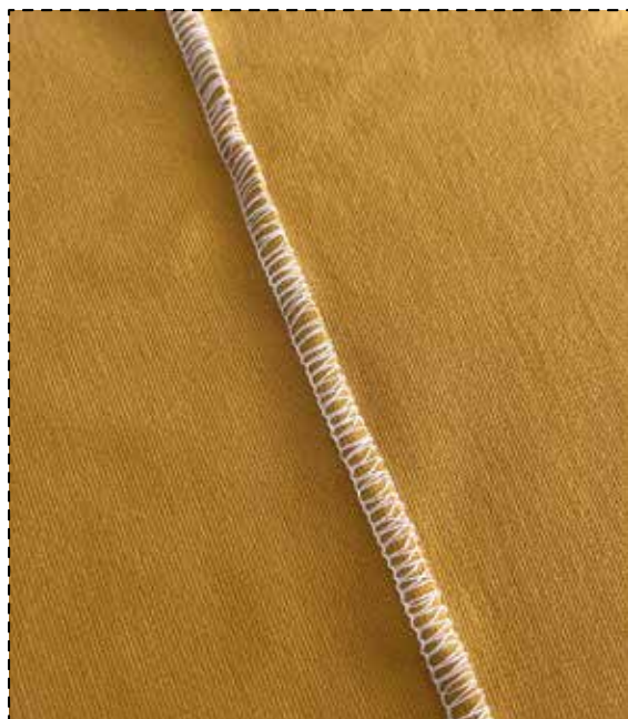
Le point flatlock, sur l'endroit du tissu.
