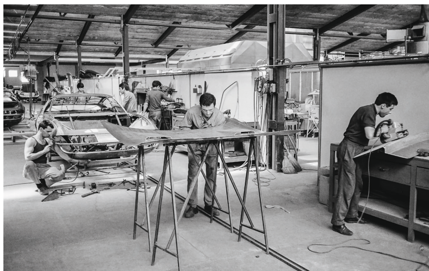
On distingue au premier plan le panneau du capot et celui du coffre en cours de préparation avant d'être placés sur la Daytona juste derrière. © Klementaski
