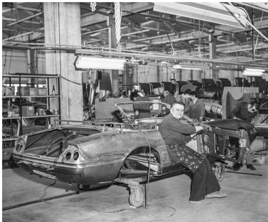
La doublure de porte est ébavurée avant la soudure du panneau extérieur. On aperçoit tout au fond les sous-ensembles empilés et les capots en attente du prochain poste. © Neill Bruce
