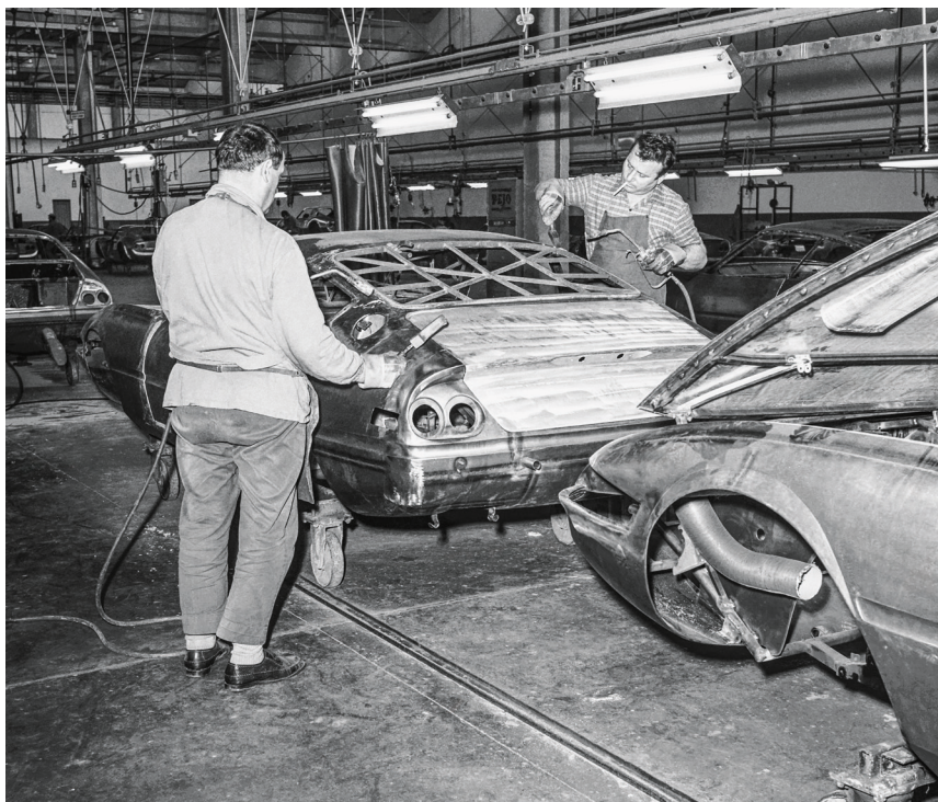
Malle arrière et capot du coupé, en aluminium, sont maintenant «ferrés» en position et l'on régularise les défauts par apport de métal fondu. © Neill Bruce
