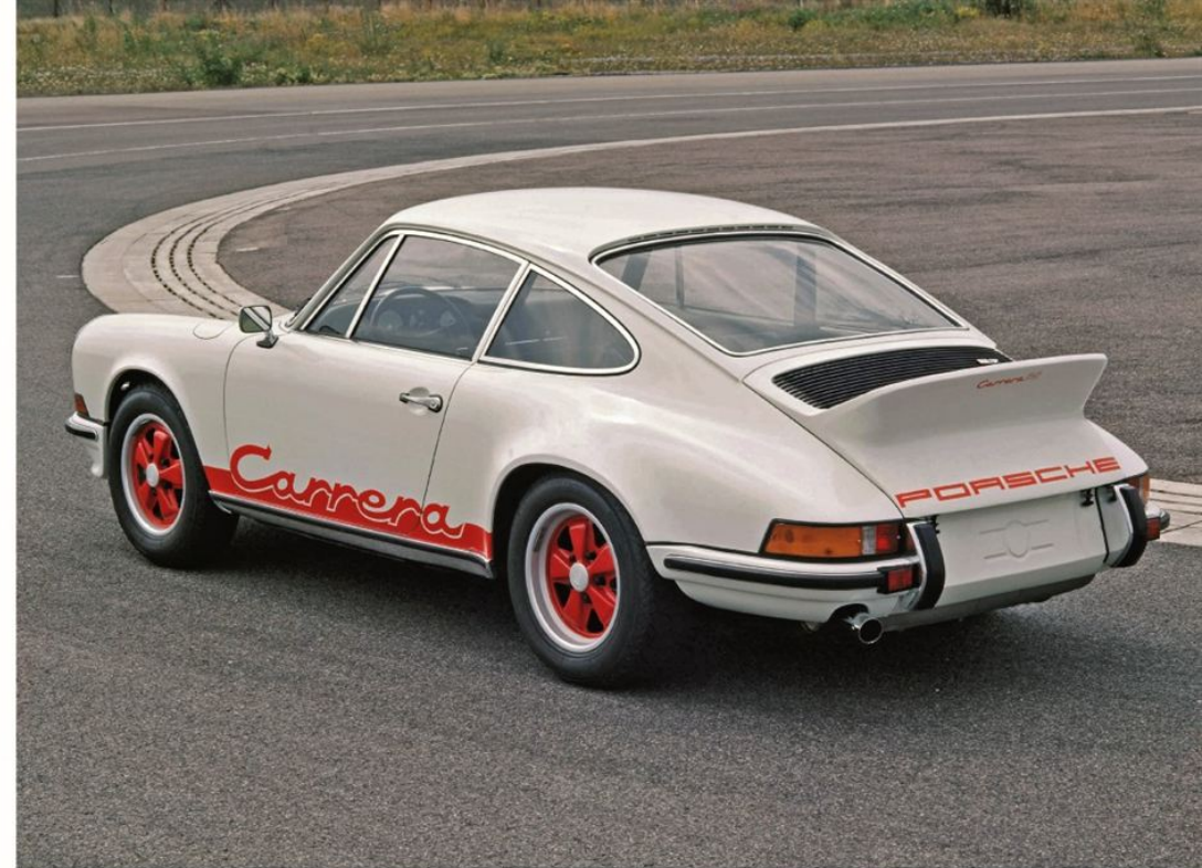
▲ Le nouveau modèle servit de référence et fut à l'origine de tendances. La version sport, avec son intérieur spartiate et dépouillé, pesait 960 kg. Son nouveau moteur Type 911/83 de 2 687 cm 3 de 90 mm d'alésage et 70,4 mm de course développait 210 ch (154 kW) à 6 300 tr/min et 255 Nm à 5 100 tr/min. (Archives Porsche)
