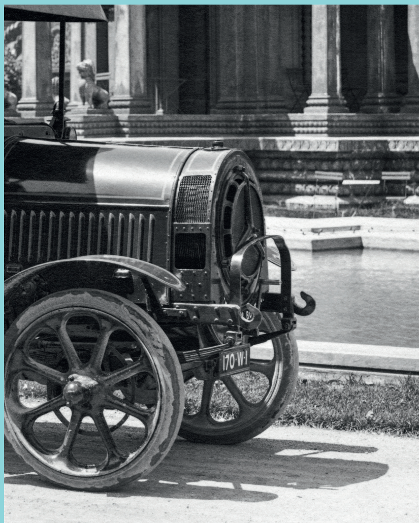
Une forme circulaire et l'étoile à trois branches sur le devant, signes distinctifs du radiateur Solex sur un De Dion-Bouton. (Archives Denis C.)
