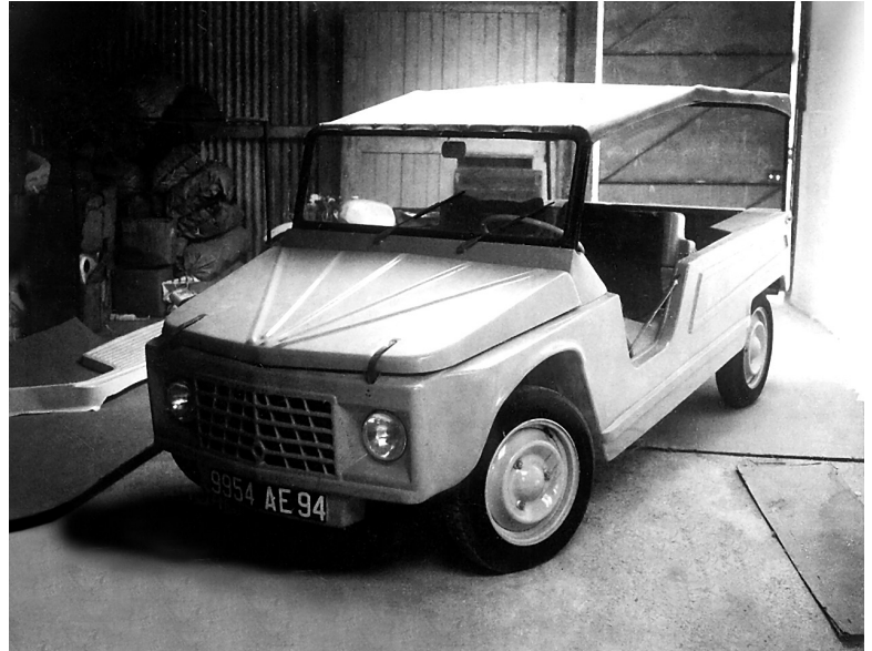
Le premier prototype de la Méhari est doté de flancs plats. Ces panneaux latéraux seront rapidement remplacés par des modèles nervurés afin de pallier un manque de rigidité de la carrosserie. (R. de la Poype)
