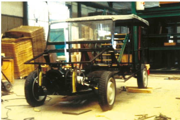
Après de sévères tests d'aptitudes « tout-chemin » au Centre d'essais Citroën, un second prototype est élaboré. Châssis renforcé, carrosserie nervurée, passages de roue agrandis sont quelques-unes des nombreuses améliorations apportées à cette seconde version. (R. de la Poype)
