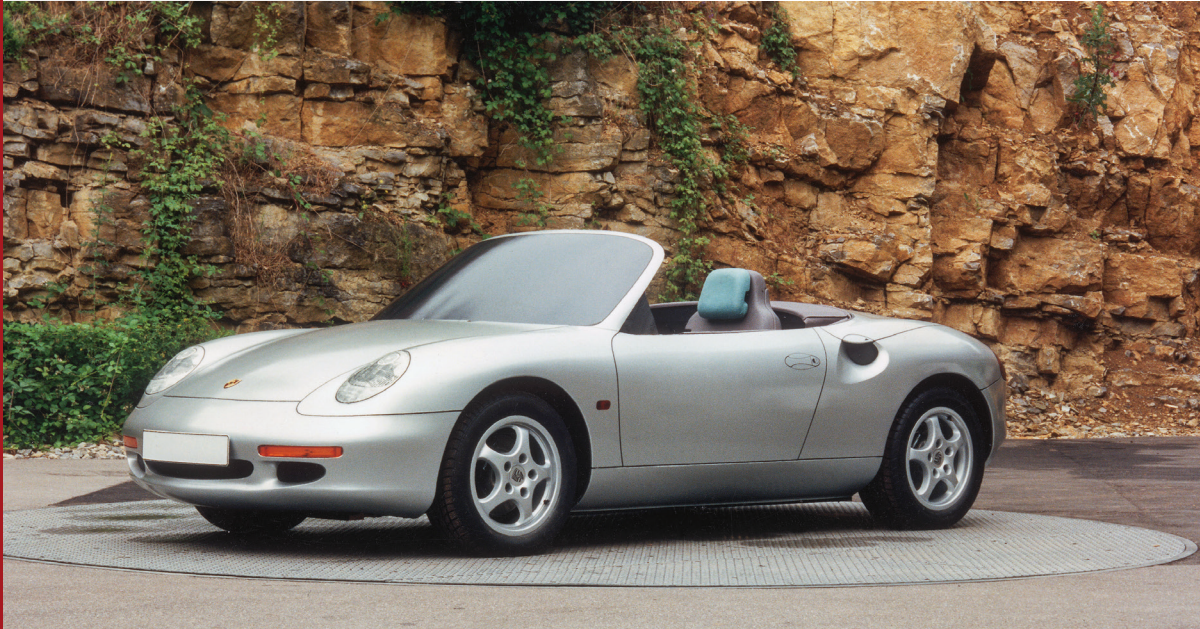
La maquette réalisée par Pinky Lai pour la Porsche 986. Le pare-brise est haut et peu incliné. Les phares sont ronds et l'entrée d'air sur les flancs a trouvé son emplacement final. Cette maquette ne sera pas retenue pour le projet 986.
