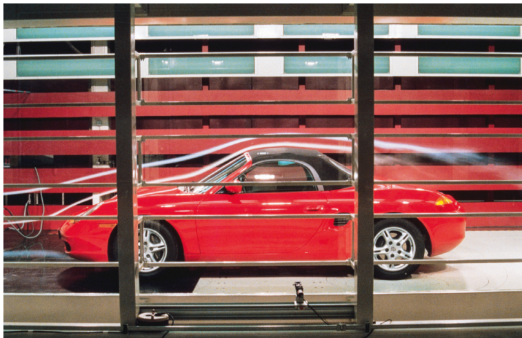
Le Boxster dans une chambre aérodynamique du centre d'essai Porsche implanté à Weissach.
