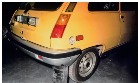
Un prototype de la version USA de la Renault 5. La décoration est chargée, avec des enjoliveurs et des baguettes qui, heureusement, ne seront pas retenus. (Archives des auteurs)
