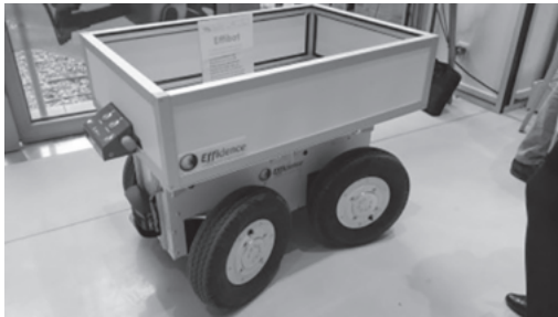
► Figure 1.27. Pivotement des roues du robot Effibot pour un virage.
