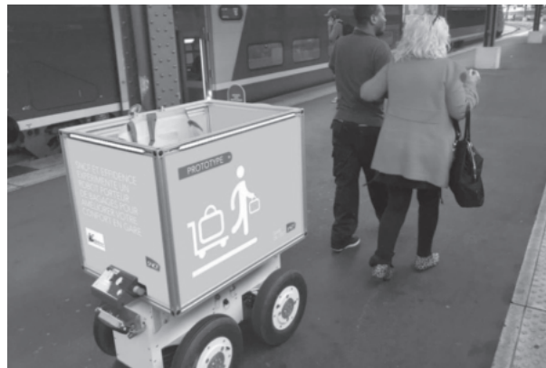
► Figure 1.26. Robot Effibot en situation de fonctionnement (suivi à distance).
